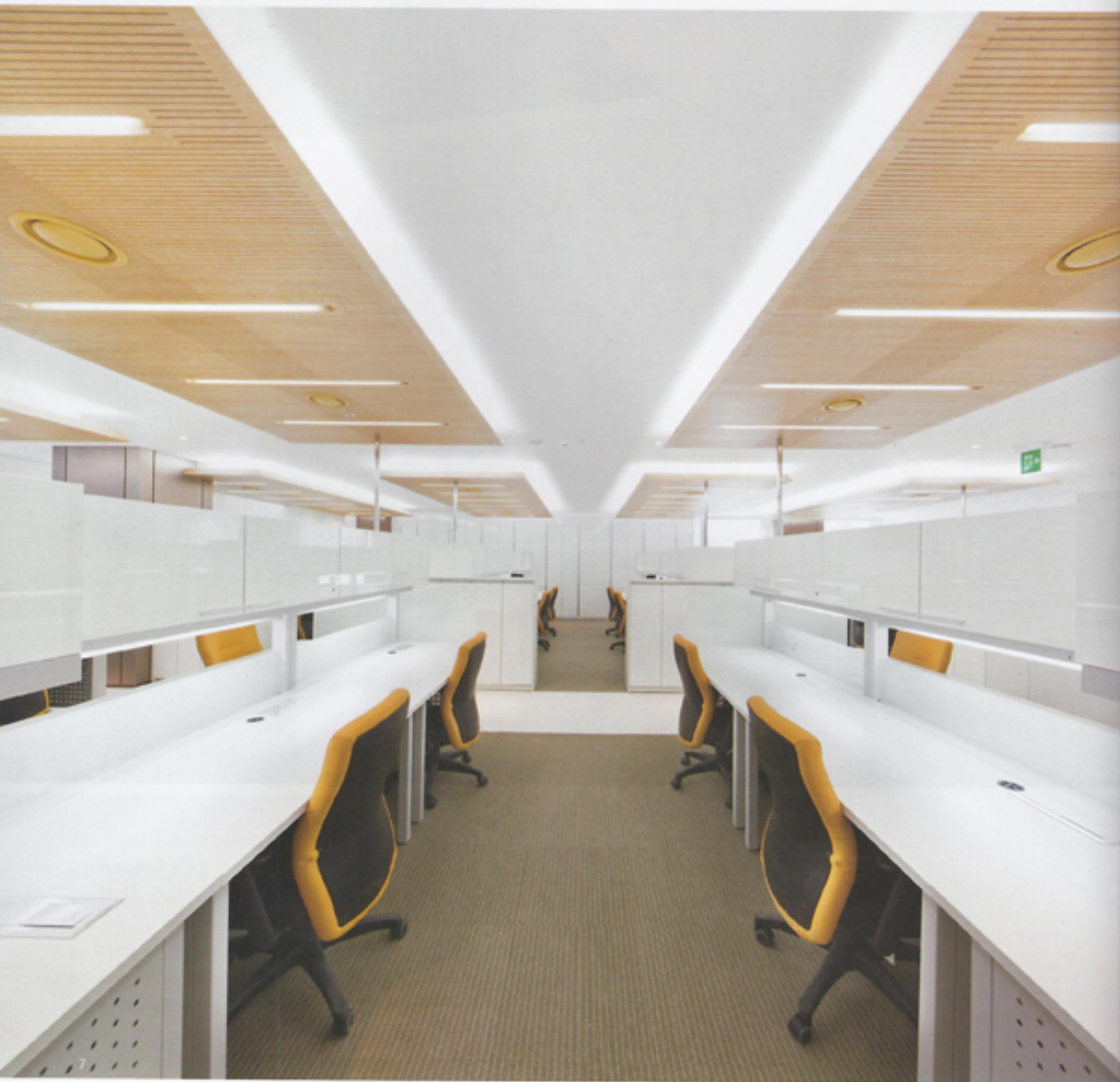
7, 8, 9. 낮은 천장고로 인해 일반적으로 업무시설에 사용하는 엑세스 플로어 대신 전기, 통신 설비가 천장에서 내려오는 독특한 방식을 채택해 현장 조건에 맞게 정리했다. 또한 부족한 수납공간을 확보하기 위해 오버헤드 수납장이 달린 오피스 가구 유닛을 디자인했다.
